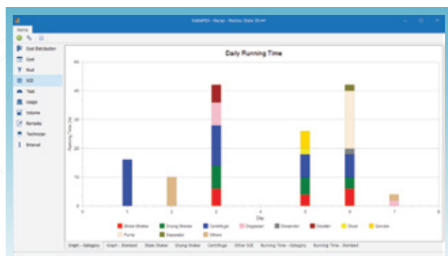
固控设备每日运行时间
